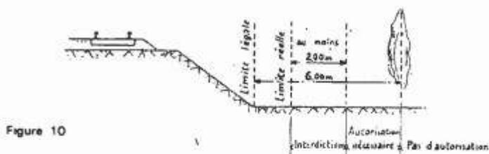
b) haies vives - Elles ne peuvent être plantées à l'extrême limite des propriétés riveraines : une distance de 2 mètres de la limite légale doit être observée, sauf dérogation accordée par le Préfet qui peut réduire cette distance jusqu'à 0,50 mètre.
