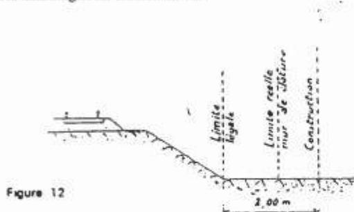
Il en résulte des dispositions précédentes que si les clôtures sont autorisées à la limite réelle du Chemin de Fer, les constructions doivent être établies en retrait de cette limite réelle dans le cas où celle-ci est située à moins de 2 mètres de la limite légale.
